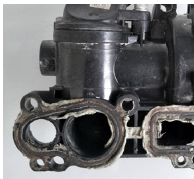
Fig. 5 : Fuites dues à des produits d'étanchéité supplémentaires (vue du dommage)
